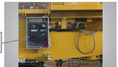
Главный выключатель для подачи сети
