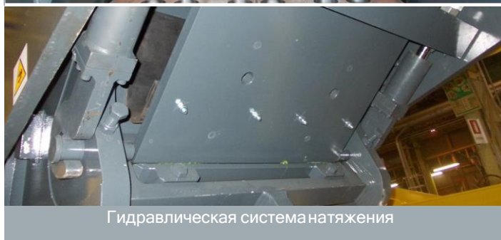
Гидравлическая регулировка зазора для предотвращения засорения
