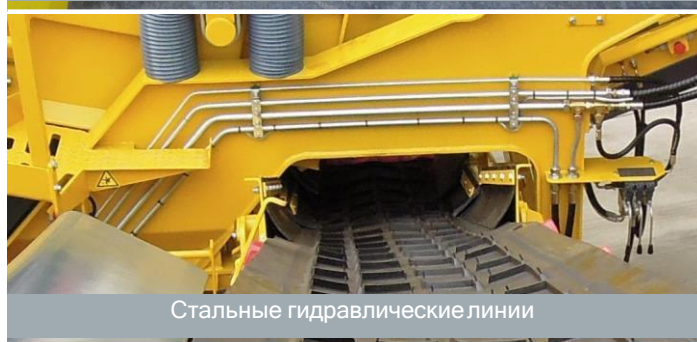
Стандартный пластинчатый питатель для тяжелых условий эксплуатации
