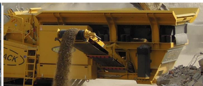
Предварительный грохот с отдельным приводом
